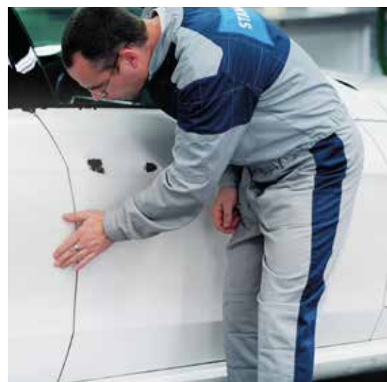
Bei der Reparatur von weißen Perlglanz-Lackierungen ist die Anfertigung von Musterblechen entscheidend, um ein einwandfreies Ergebnis zu erreichen.
